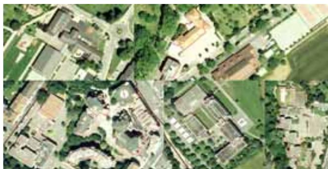
Abbildungen 110 und 111: **Solarpotenzial im Blickfeld.** Wie kann das Potenzial erfasst werden? Gebäudestatistiken, Katasterpläne und Luftbilder sind die wichtigsten Quellen zur Abschätzung des Potenzials. Die solar-architektonische Eignung der Dächer wird durch Interpretation der statistischen Gebäudedaten und
