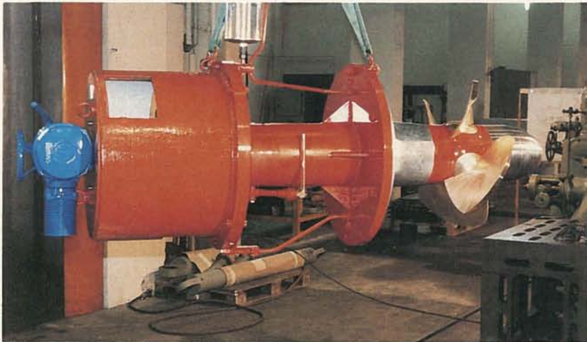
Turbine en montage en atelier
