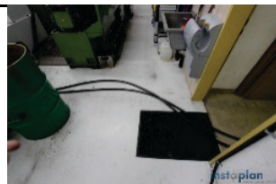
Abbildung 22: Schläuche als Stolperfallen, Arbeitssicherheit
