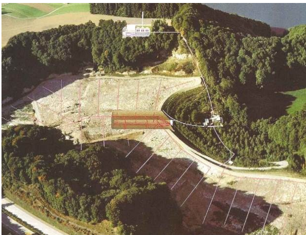
Deponiegasfassung für die energetische Nutzung
