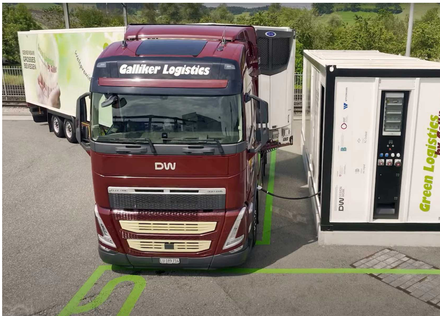
Während des neunmonatigen Piloteinsatzes beim Transportunternehmen Galliker wurden mit dem Mega-Charger batterieelektrische 32-t-Lkw mit 680-kWh-Batterie und 40-t-Lkw mit 900-kWh-Batterie (Foto) geladen. Foto: BFE-Schlussbericht Mega-Charger
