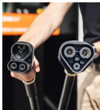
Der Ladestecker des Mega-Chargers (rechts) verwendet den MCS-Standard und ist grösser als die herkömmlichen Ladestecker mit CCS-Standard (links). Foto: BFE-Schlussbericht Mega-Charger
