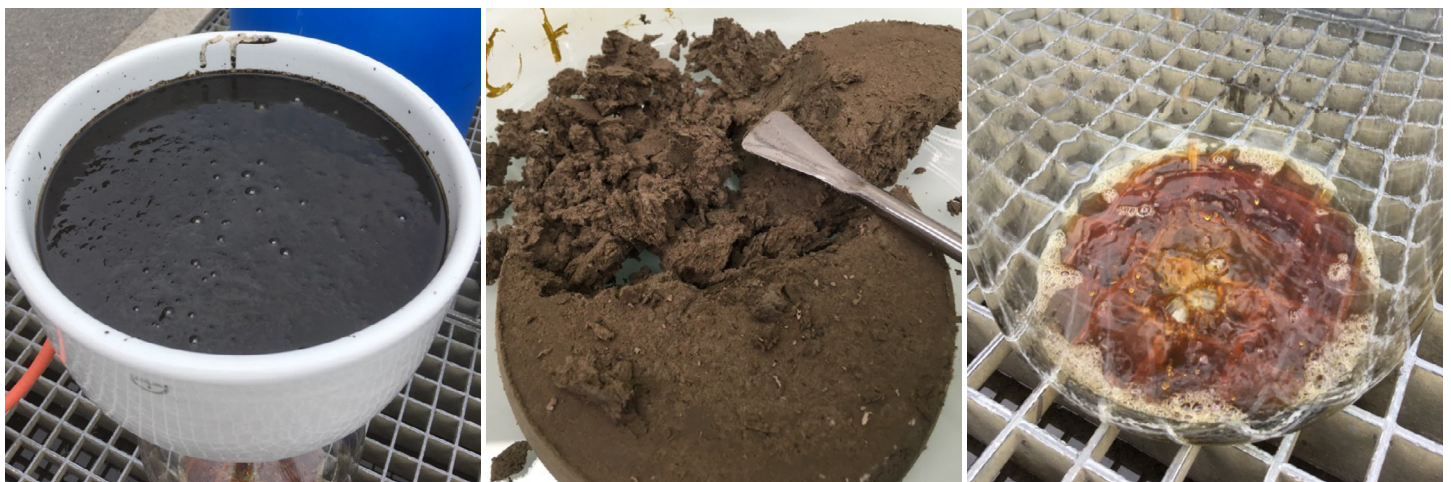
Aus dem Kohle-Wasser-Gemisch (links) entstehen im Prozessschritt der Hydrothermalen Karbonisierung HTC-Kohle (Mitte) und Prozesswasser (rechts). Fotos: Schlussbericht VARESI
