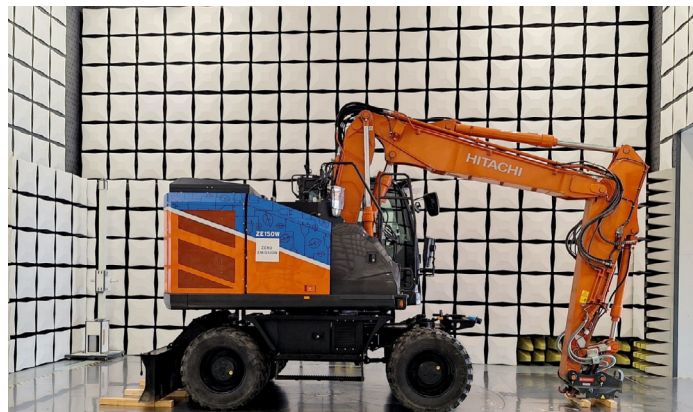
Der elektrische Bagger ZE150W im Prüflabor für elektromagnetische Verträglichkeit (EMV). Foto: SUNCAR
