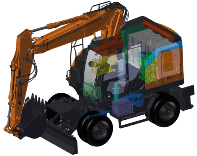
Hinter der Fahrerkabine befindet sich die 1.7 m x 1 m x 1 m grosse Batterie, bestehend aus drei übereinander gestapelten Batterieblöcken: Sie liefern den Strom für die elektrifizierten Komponenten des Fahrzeugs. Illustration: BFE-Schlussbericht
