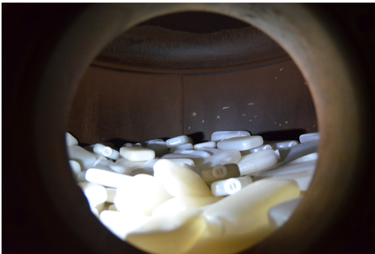
Jede Kapsel des Speichers, der im Pilotprojekt untersucht wurde, enthält 110 ml PCM auf Basis von Salzhydrat. Foto: Schlussbericht SunStore
