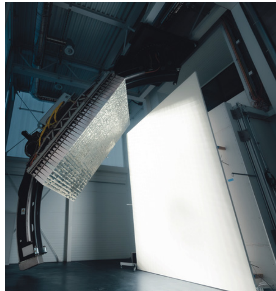
Die künstliche Sonne besteht aus 875 Leuchtdioden und ermöglicht Fassadentests unter Echtbedingungen.
