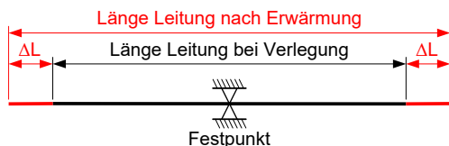
Bild 4.51 Längendehnung eines beidseitig eingespannten Bauteils (nach [172]).
