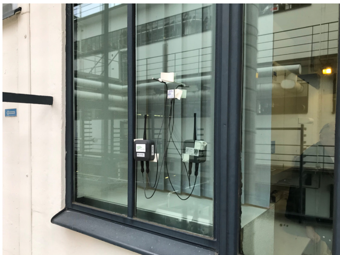
Messung des U-Werts der Fensterverglasung an einem Gebäude des Pharmaunternehmens Roche in Basel, das im Rahmen des Projekt FenSanReuse untersucht wurde. Foto: INEB
