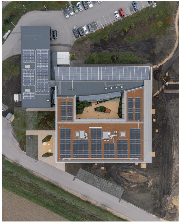
Das österreichische Unternehmen «Windkraft Simonsfeld» betreibt eine Reihe von Windkraft- und Solarstromanlagen – und produziert selber an ihrem Hauptsitz in Ernstbrunn mit einer leistungsstarken PV-Anlage (70 kW) Solarstrom. Wie dieser für die Selbstversorgung der firmeneigenen E-Auto-Flotte genutzt werden kann, wurde im Rahmen des GAMES-Projekts untersucht. Foto: Windkraft Simonsfeld
