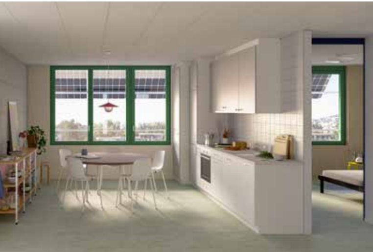
Im Innenraum treten die Solarmodule als perforierter Sonnenschutz in Erscheinung.
