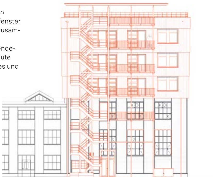
Abbildung 1.4: Da die wiederverwendeten Alubleche unterschiedliche Profilformate aufwiesen und um Zuschnittverluste zu vermeiden, wurde die Aussenhülle geschuppt. (Plan: baubüro in situ)
