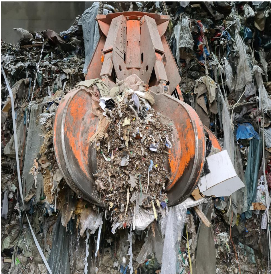
Abbildung 1: Ein Greifer hebt gemischten Abfall in einer KVA
