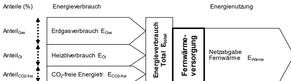
Bild 5.2 Energieflussdiagramm bei Fernwärmeversorgungen ohne Kehrlichtverbrennungsanlage (FW1)
