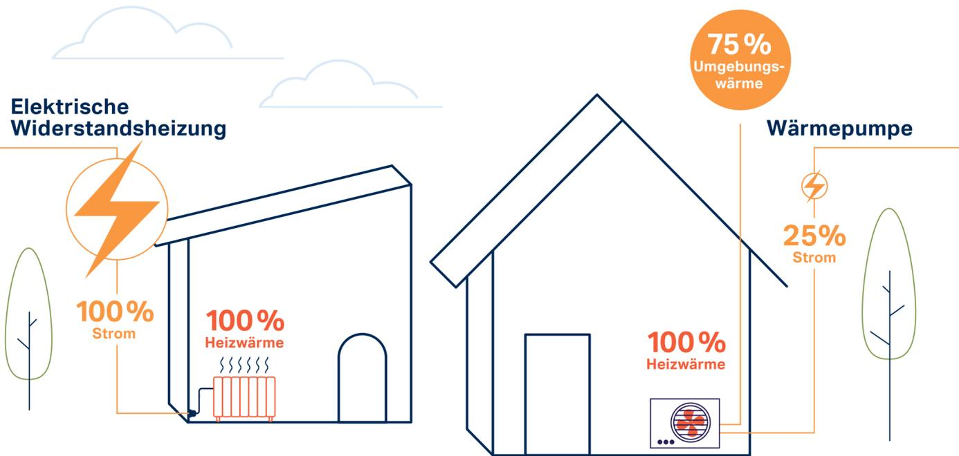
Um Wärme zu produzieren, verbrauchen elektrische Widerstandsheizungen viel Strom. Wärmepumpen hingegen müssen nur einen Bruchteil des Stroms aufwenden, weil sie Umgebungswärme nutzen. Damit ist natürliche Wärme gemeint, die in der Luft, in der Erde, im Grundwasser und in Oberflächengewässern gespeichert ist.
