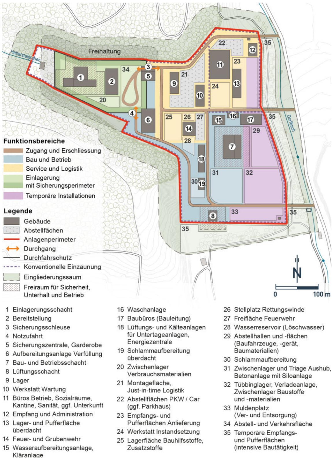
Fig. C-2: Exemplarische Anordnung von Bauten und Anlagen in Nutzungsabschnitt 2
