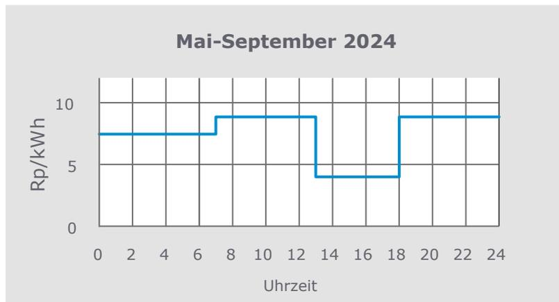
Der statische Tarif aus dem Pilotprojekt in Winkel bleibt über mehrere Monate gleich. Er basiert auf stündlichen Durchschnittswerten der Netzauslastung über mehrere Jahre und reagiert daher nicht auf aktuelle Entwicklungen (Quelle: EKZ, bearbeitet).
