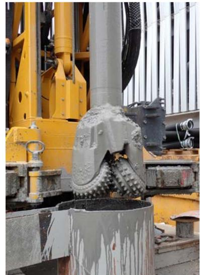
Ab einer Bohrtiefe von 34 m kam ein Spülbohrgerät mit einem sogenannten Rollenmeißel als Bohrkopf zum Einsatz (Bildquelle: Geo Explorers AG).
