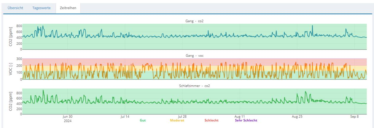
Abbildung 8. Visualisierungen im Modul Raum > Luftqualität. Oben: Die Übersicht zeigt, wie viel Prozent der Zeit die gemessene Luftqualität gut, ausreichend oder ungenügend war. Als Messgrößen dienen die CO<sub>2</sub>-Konzentration und der VOC-Index. Mitte: Die Tageswerte erlauben eine zeitliche Einordnung der Luftqualität. Unten: Mit Hilfe von Zeitreihen kann die Luftqualität detailliert untersucht werden.
