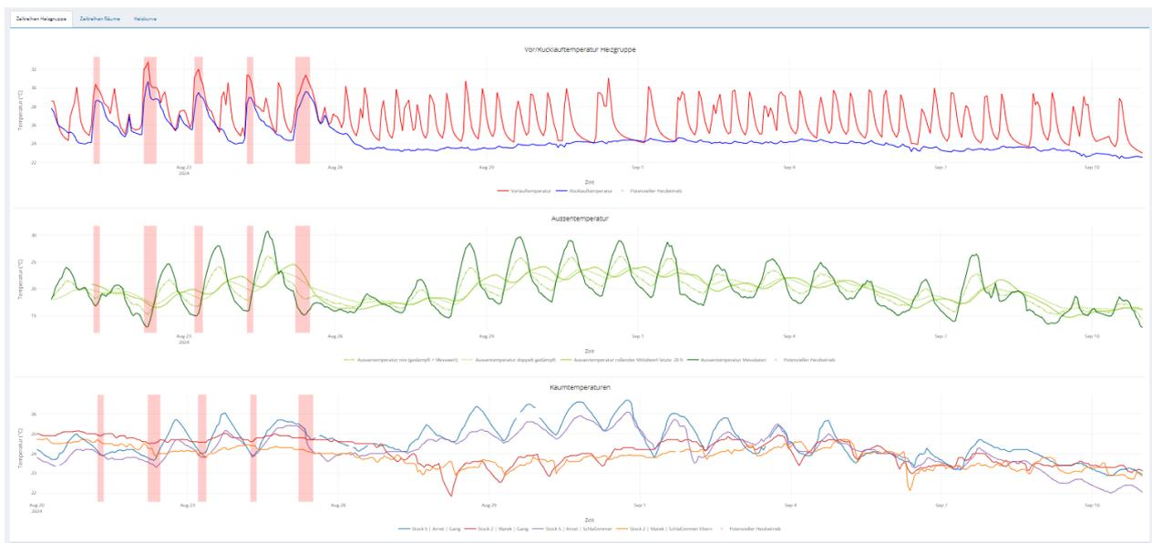
Abbildung 12. Visualisierungen im Modul Zentral > Heizkurvenoptimierung. Diagramm oben: Heizgruppenvorlauf- und Rücklauftemperaturen, Mitte: Aussentemperaturen (Sensormesswert, gemittelt, gemittelt und gedämpft), unten: Raumtemperaturen. Rot markiert sind Bereiche, in denen die Heizung aktiv war. In diesem Fall wurde im Sommer geheizt und danach die Heizgrenze angepasst.
