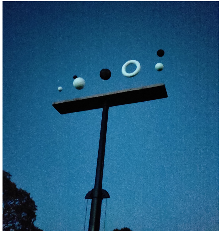
Testanlage, mit der geprüft wurde, ob sich Objekte abhängig von Grösse, Form und Farbe mit Infrarotstrahlung erkennen lassen. Foto: Schlussbericht AMM-FAUNA
