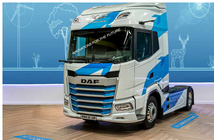
Diesen Lkw mit Wasserstoff-Verbrennungsmotor hat der niederländische DAF-Konzern 2022 vorgestellt. Mit dem Prototyp wurden erste Strassentests durchgeführt, er ist aber noch nicht auf dem Markt. Foto: DAF Trucks
