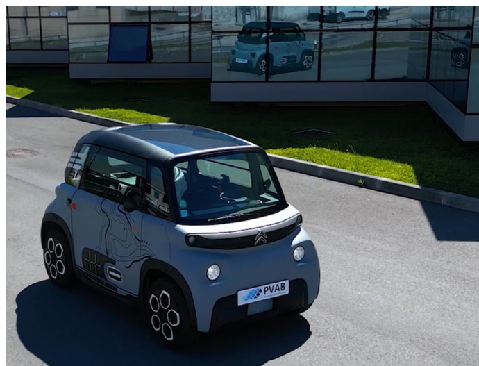
Der Citroën AML, ausgerüstet mit einem Solardach aus Kunststoff. Foto aus: Julien Robin, et al. «PhotoVoltaic Automotive Body (PVAB) Project Outcome of 3 years of VIPV R&D industrial project» in PVinMotion2024, 6-8 March 2024 in Neuchâtel.
