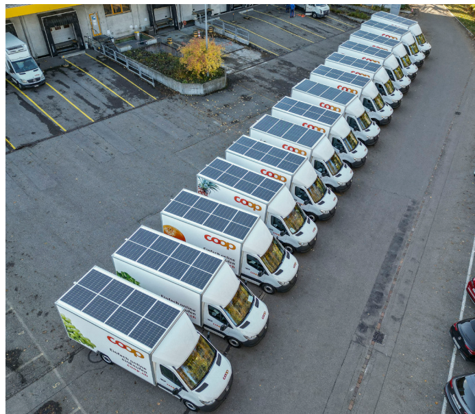
Lieferfahrzeuge von COOP sind heute teilweise schon mit Solar-dächern ausgestattet. Der Solarstrom wird bislang genutzt, um die Batterien der Kühlaggregate mit Strom zu versorgen und um sicherzustellen, dass den Telematik-Einheiten durchgehend Energie zugeführt wird. Foto: David Lambelet
