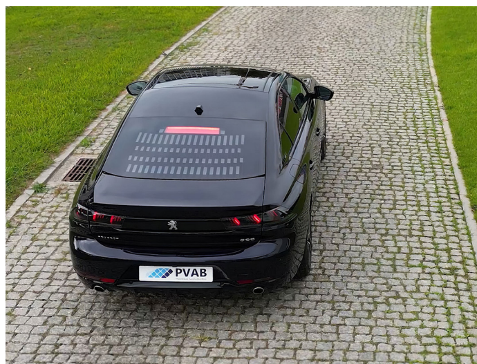
Bei diesem Peugeot 508 wurde die Heckscheibe durch ein Kunststoff-Modul mit Solarzellen ersetzt. Foto aus: Julien Robin, et al. «PhotoVoltaic Automotive Body (PVAB) Project Outcome of 3 years of VIPV R&D industrial project» in PVinMotion2024, 6-8 March 2024 in Neuchâtel.
