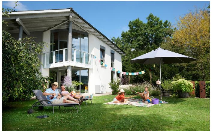
Bei Neubauten sind Wärmepumpen (in der Bildmitte an der Hauswand: eine Luft-Wasser-Wärmepumpe, die Umweltwärme aus der Umgebungsluft nutzt) heute das meistgenutzte Heizsystem. Maximale Effizienz erreichen die Geräte aber nur, wenn sie optimal eingestellt sind. Foto: EKZ
