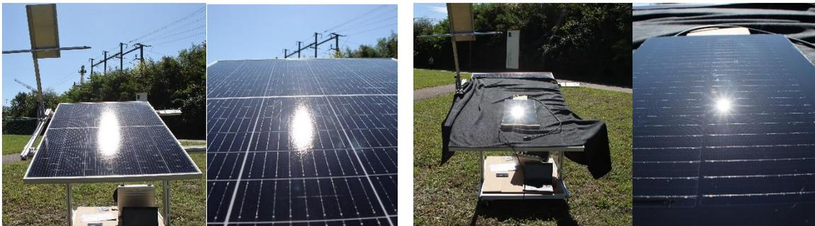
Abbildung 21: Blendfleck auf Standard-Solarglas (zwei Bilder links) und Floatglas (zwei Bilder rechts) aus unterschiedlichen Distanzen. Trotz unterschiedlichen Distanzen sind Charakteristik und Grösse der Blendflecken beim gleichen Glas sehr ähnlich. Quelle: Ch. Bucher et al., «Two-Dimensional Representation of the Bidirectional Reflectance Distribution Function of Photovoltaic Modules», EUPVSEC 2023, Lissabon.
