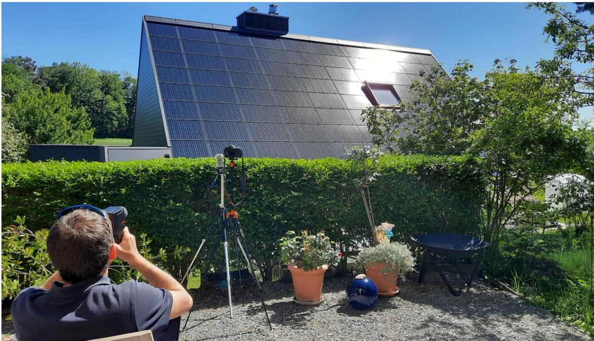
Abbildung A3-1: Feldmessungen (Leuchtdichte) an einer blendenden PV-Anlage.
