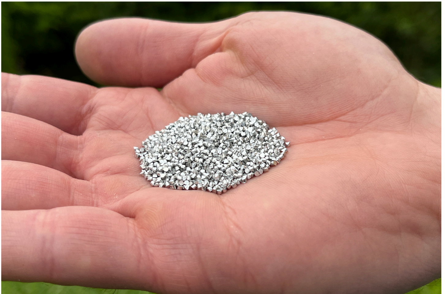
Aluminium-Granulat für die Produktion von Wärme und Wasserstoff im Winter, mit einer Energiespeicherdichte von über 15 MWh pro m 3 Schüttgut. Foto: jebe-arts.ch.
