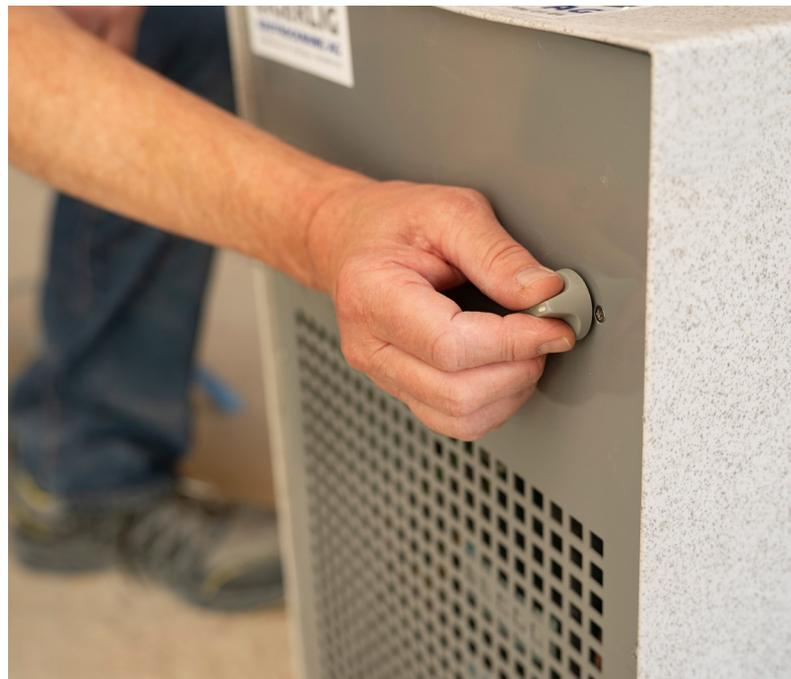
Entfeuchter sollen nur laufen, wenn es nötig ist: Modelle mit Hygrostat schalten sich automatisch ab, wenn die gewünschte Luftfeuchtigkeit unterschritten wird.
