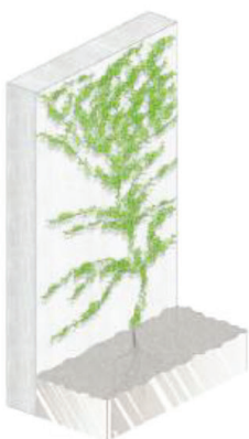
Direktbewuchs der Fassade
