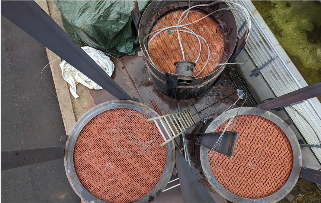
Ansicht der Korbeinsätze mit den Formsteinen aus Keramik (gebranntem Ton; unten links und rechts im Bild) und den Formsteinen der Firma Kraftblock (bestehend aus einem Schlackepulver, das mit Phosphat-Binder verpresst und dann bei relativ niedrigen Temperaturen gebrannt wird; Mitte oben im Bild). Die Korbeinsätze haben einen durchlässigen Boden und werden im Versuchsbehälter übereinandergestapelt. Foto: DLR
