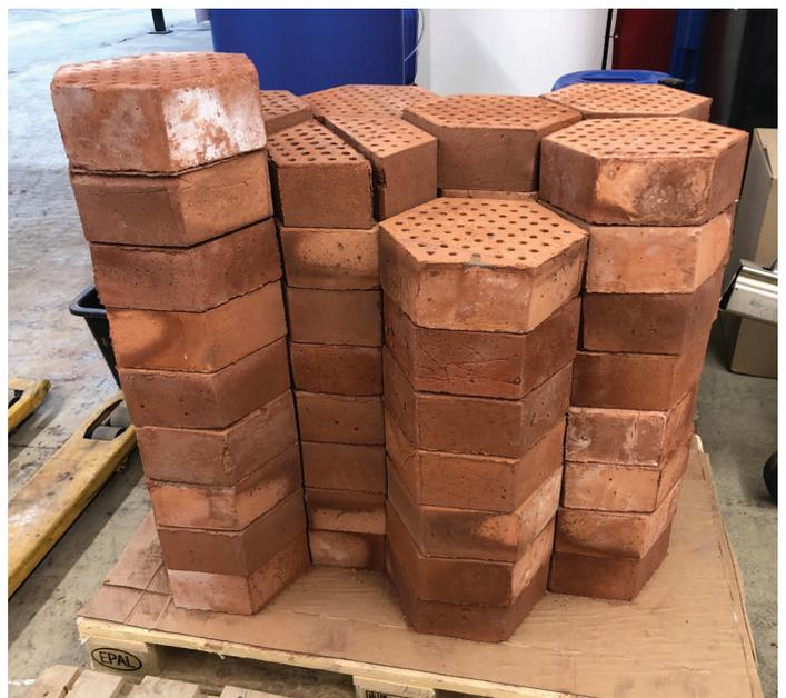
Formsteine aus Hochofen-Schlacke, die als Füllmaterial experimentell getestet wurden (hier ausserhalb des Tanks). Im Tank eingesetzt, werden die Löcher von Flüssigsalz durchströmt. Das erhöht die Wärmeübertragung auf das Füllmaterial. Foto: Kraftblock
