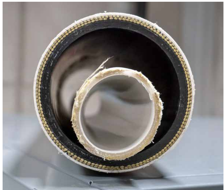
Die CO 2 -führende innere Leitung wird aus Sicherheitsgründen von einem weiteren Rohr umgeben (Bildquelle: HES-SO Valais-Wallis).
