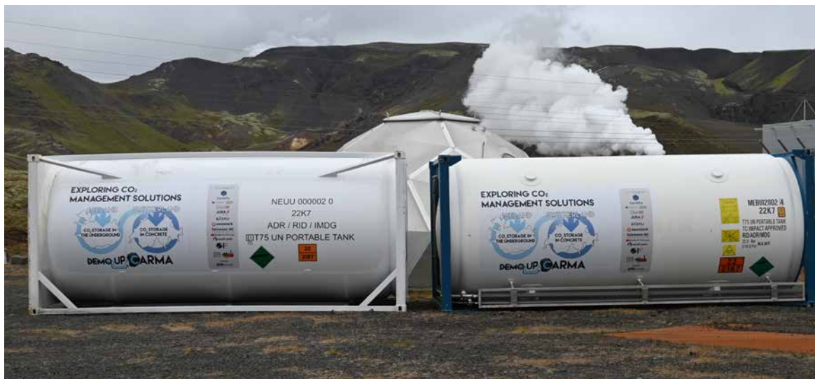
In speziellen Containern wird das verflüssigte CO 2 per Lastwagen, Bahn und Schiff von der Schweiz nach Island transportiert (Bildquelle: DemoUpCARMA/ETH Zürich).
