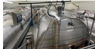
Abbildung 1: Drei Käsefertiger mit einem Fassungsvermögen von jeweils 18.000 Litern
