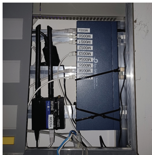
Modem und Router, wie sie beim Feldversuch in Rolle eingesetzt wurden. Foto: Romande Energie/HSLU
