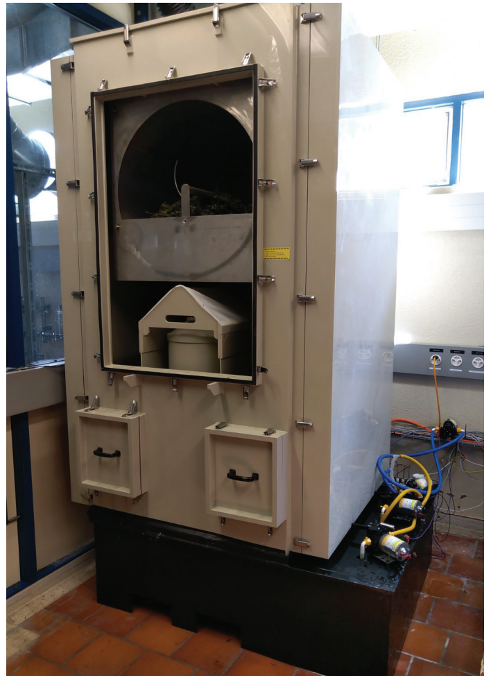
Funktionsmuster des Absorptionstrockners der ZHAW: Die Anlage hat eine Trocknerfläche von einem Quadratmeter. Darauf können Brennesseln, Apfelminze, Pfefferminze und weitere Kräuter bis zu einem Feuchtigkeitsgehalt von 12 % getrocknet werden. Foto: ZHAW
