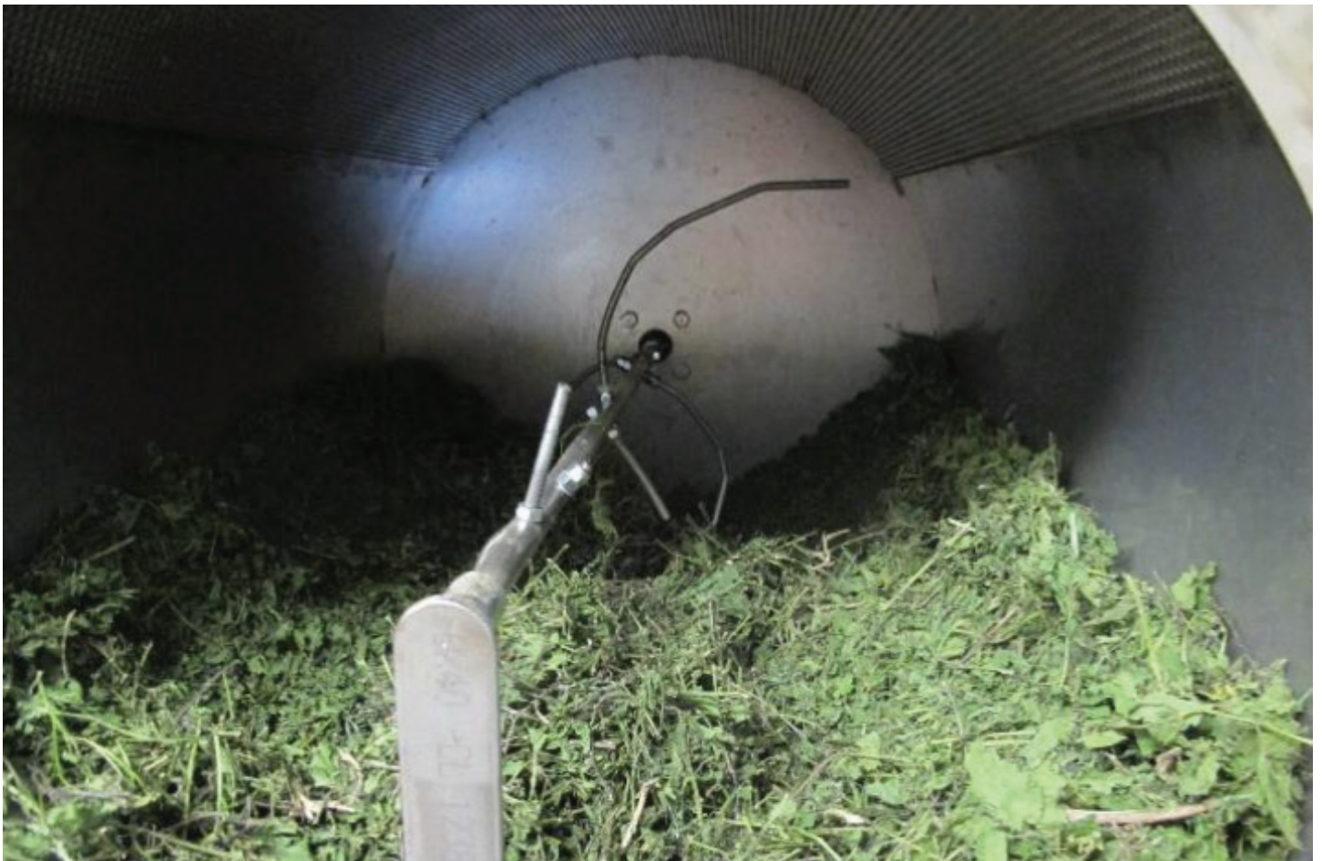
Das Rührwerk der neuartigen Trocknungsanlage sorgt dafür, dass die Kräuter gleichmässig getrocknet werden und keine Feuchtigkeitsnester verbleiben. Foto: ZHAW
