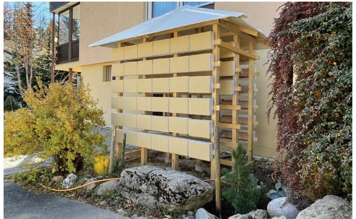
Mit diesem Testaufbau wurden beim Haus in Lenzerheide zwei Baustoffe (Tonziegel, poröser Beton) bezüglich Wasseraufnahme und Wirksamkeit der Beschichtung während zwölf Monaten untersucht. Foto: Daniel Sanz Pont
