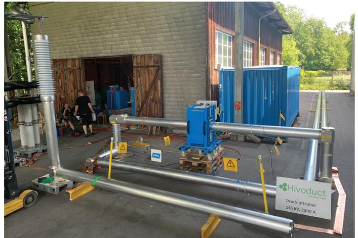
Vor dem Bau der Demonstrationsanlage in Zürich-Seebach waren die Druckluftkabel im Rahmen eines Innosuisse-Projekts und gemeinsam mit der Ostschweizer Fachhochschule auf einem Teststand der Fachkommission für Hochspannungsfragen (Versuchsanstalt Dänikon) getestet worden. Foto: Hivoduct
