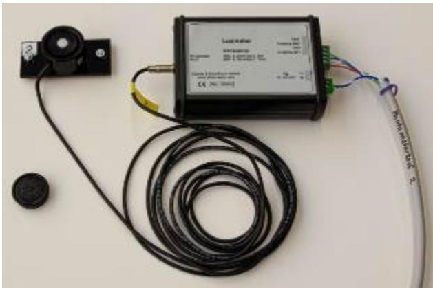
Abbildung 15: Photometerkopf und A/D-Wandler
