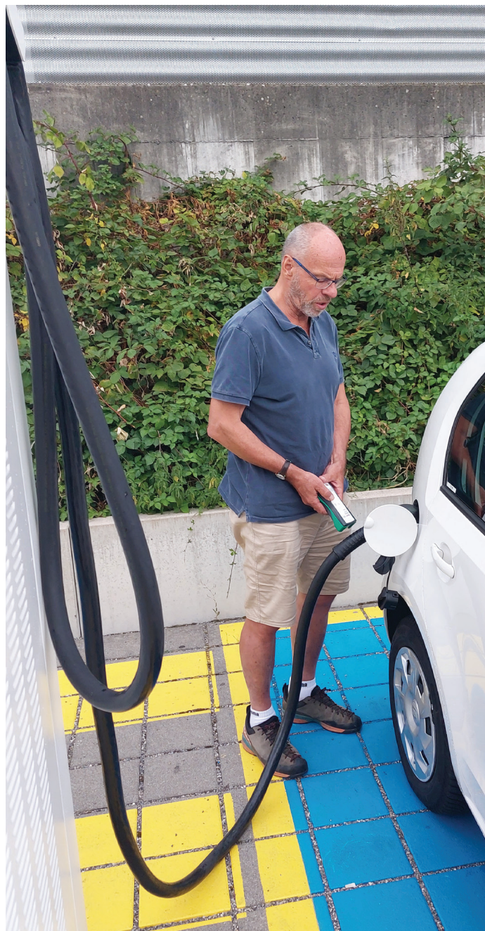
Messung des Magnetfeldes während des Ladens. Foto: Fields at Work
