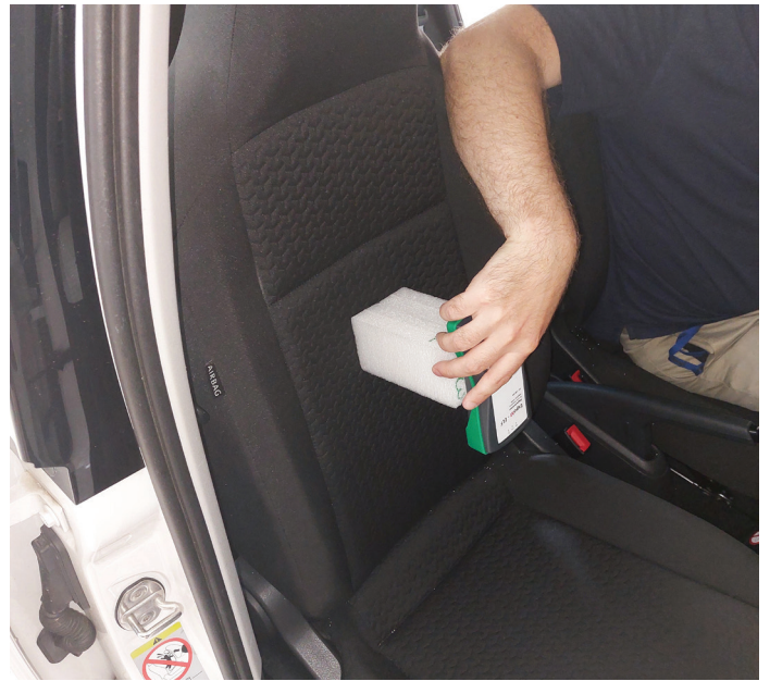
Messgerät für niederfrequente Magnetfelder auf einem Rücksitz. Da die Stärke von EMF-Feldern nach Ort variiert, wurden drei Positionen ausgemessen: direkt an der Rückenlehne, ca. 5 cm von der Lehne entfernt, ca. 10 cm von der Lehne entfernt (Bild). Foto: Fields at Work
