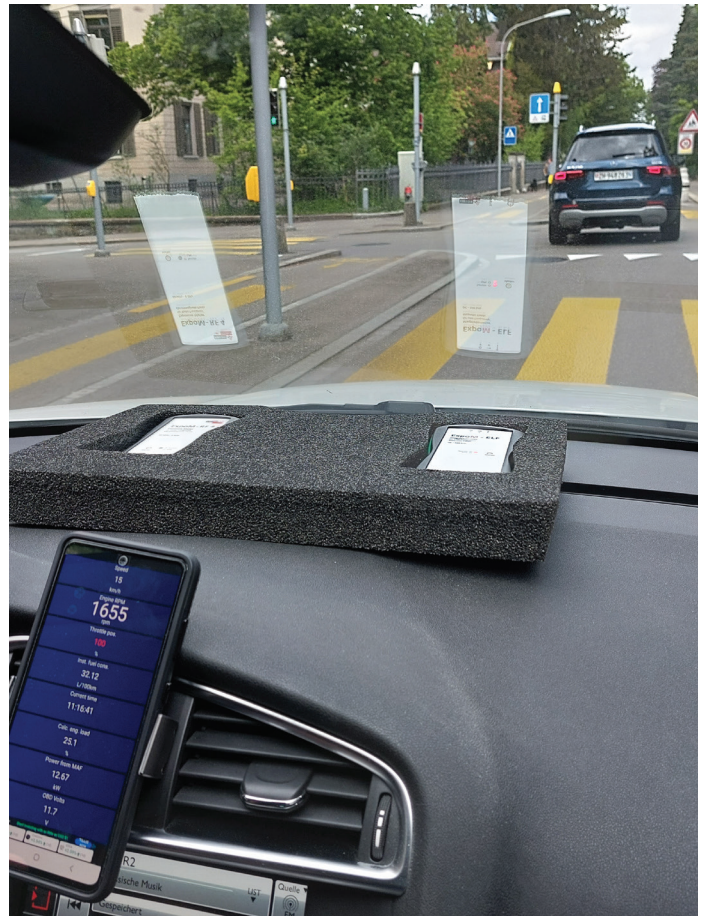
Das Gerät links unter der Windschutzscheibe misst hochfrequente elektromagnetische Felder, das Gerät rechts Magnetfelder tiefer Frequenz. Foto: Fields at Work
