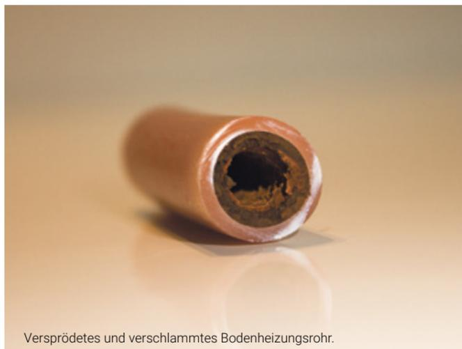
Versprödetes und verschlammtes Bodenheizungsrohr.
