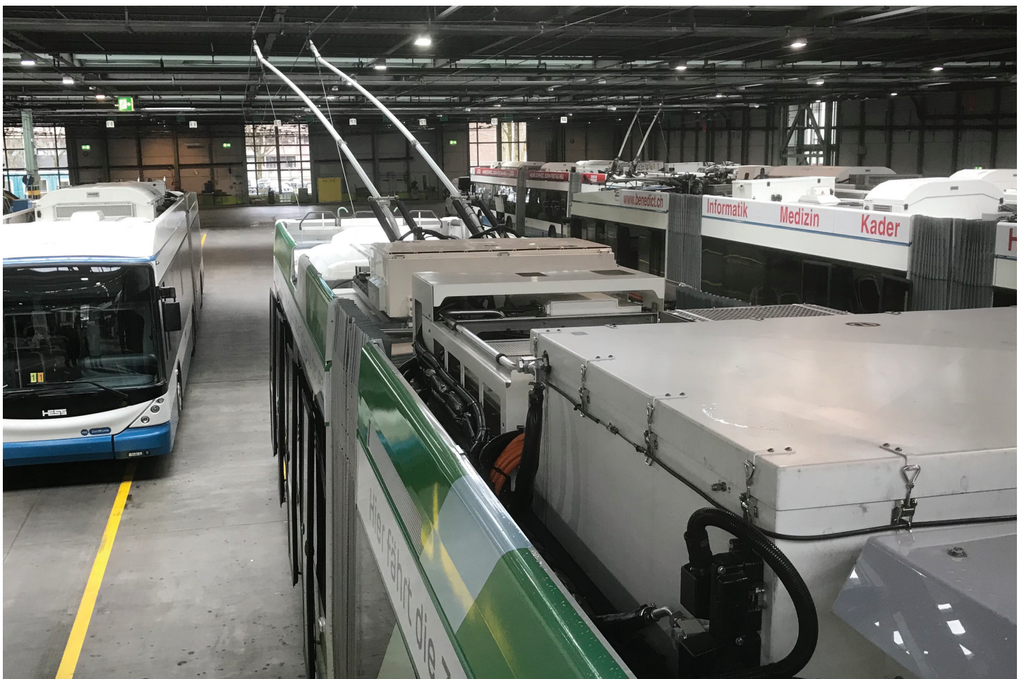
Die Batterie auf dem Dach ermöglicht diesem Trolleybus, auch Strecken ohne Oberleitungen zu meistern. Foto: B. Vogel
