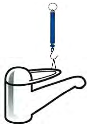
Abb3: Die Messung erfolgt mit einer Federwaage
