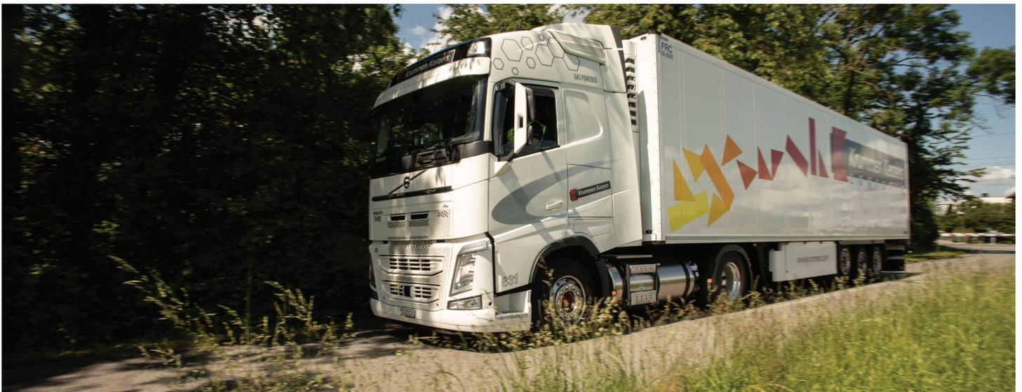
Während LKW mit komprimiertem Erdgas (CNG) Reichweiten von 200 bis 300 km haben, sind es beim LNG-Lkw (Bild) aus Volvo-Produktion, den Krummen Kerzers einsetzt, bis zu 1000 km. Hierbei ist allerdings zu berücksichtigen, dass das LNG-Fahrzeug nicht nur mit einem LNG-Tank (205 kg), sondern zusätzlich mit einem Diesel-Tank (170 l) ausgerüstet ist, der einen Teil der grösseren Reichweite sicherstellt. Foto: Krummen Kerzers.
