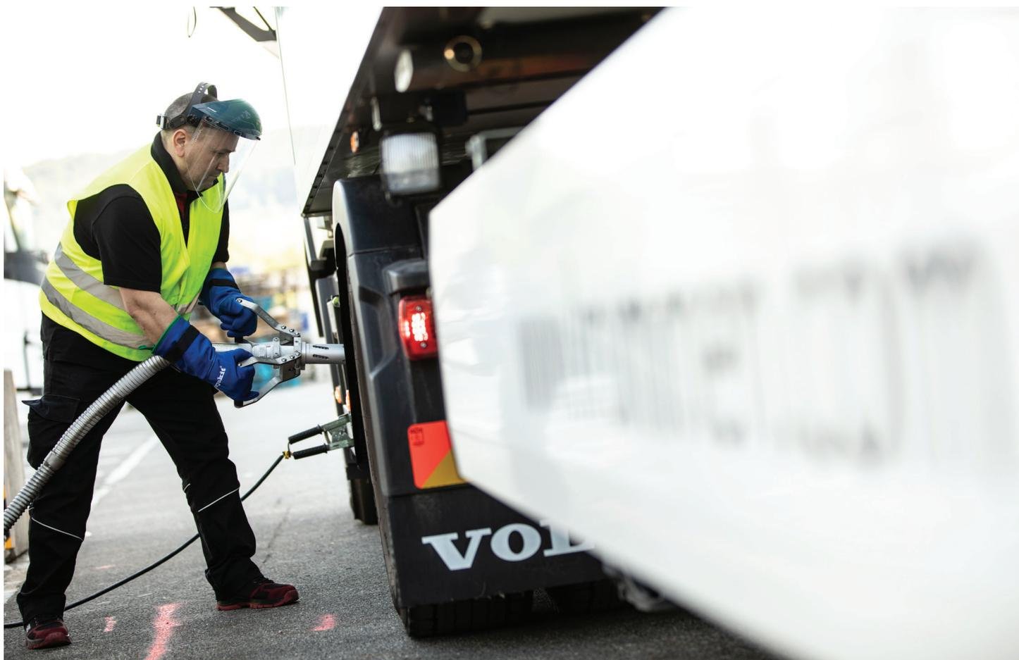
Der Einsatz von LNG bzw. LBG ermöglicht LKW nicht nur Reichweiten, die mit jenen von Dieselfahrzeugen vergleichbar sind, sondern verkürzt auch die Betankungsdauer gegenüber der Nutzung von CNG. Foto: Krummen Kerzers
