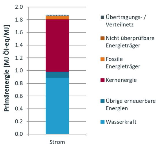
Fig. A.1 Beiträge der wichtigsten Stromqualitäten und des Übertragungs- und Verteilnetzes zur Primärenergie des HKN-Lieferantenstrommix Schweiz 2021. Die Beiträge der Infrastruktur werden für jeden Prozess separat als schraffierte Flächen dargestellt.
