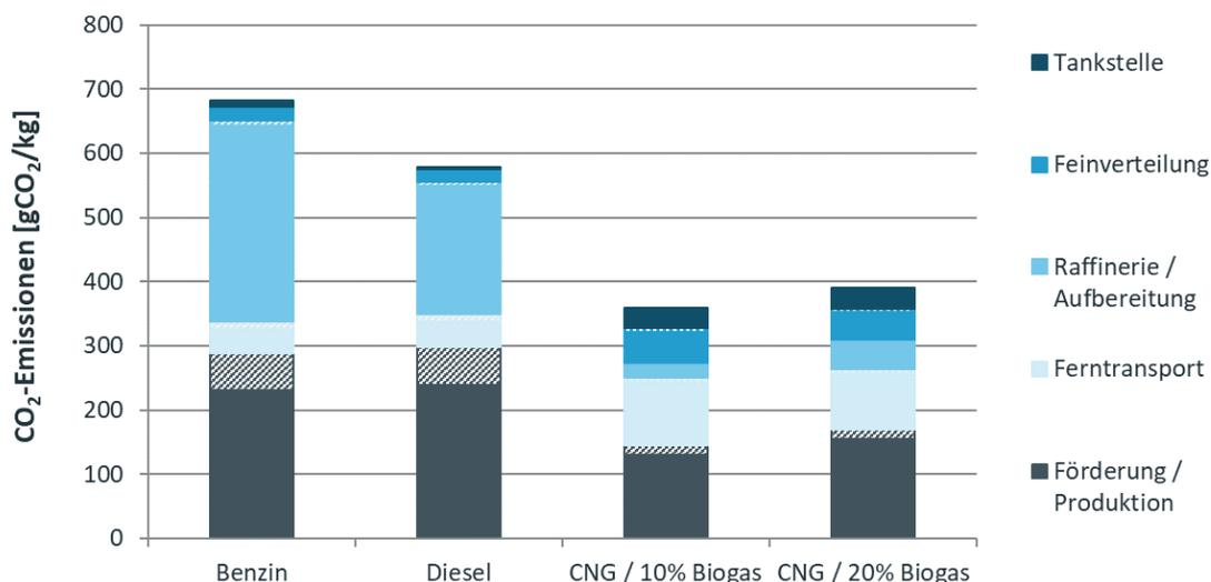
Fig. 4.2 Beiträge der wichtigsten Prozesse zu den fossilen CO<sub>2</sub>-Emissionen der Treibstoffe Benzin, Diesel, CNG / 10 % Biogas und CNG / 20 % Biogas. Die Beiträge der Infrastruktur werden für jeden Prozess separat als schraffierte Flächen dargestellt.
