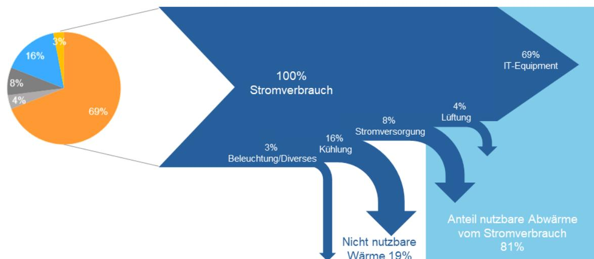
Für die externe Abwärmenutzung wird die überschüssige Wärme eines Rechenzentrums ausgekoppelt. Die Abwärme kann, je nach Umgebung, in ein neues oder in ein bestehendes Wärmenetz eingespeist werden. Das in der
