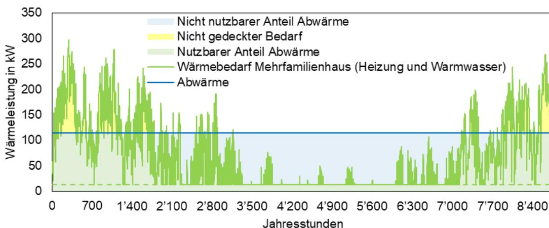
Abbildung 13: Überlagerung Jahresprofile Abwärme und Bedarf – Kleines, älteres RZ
