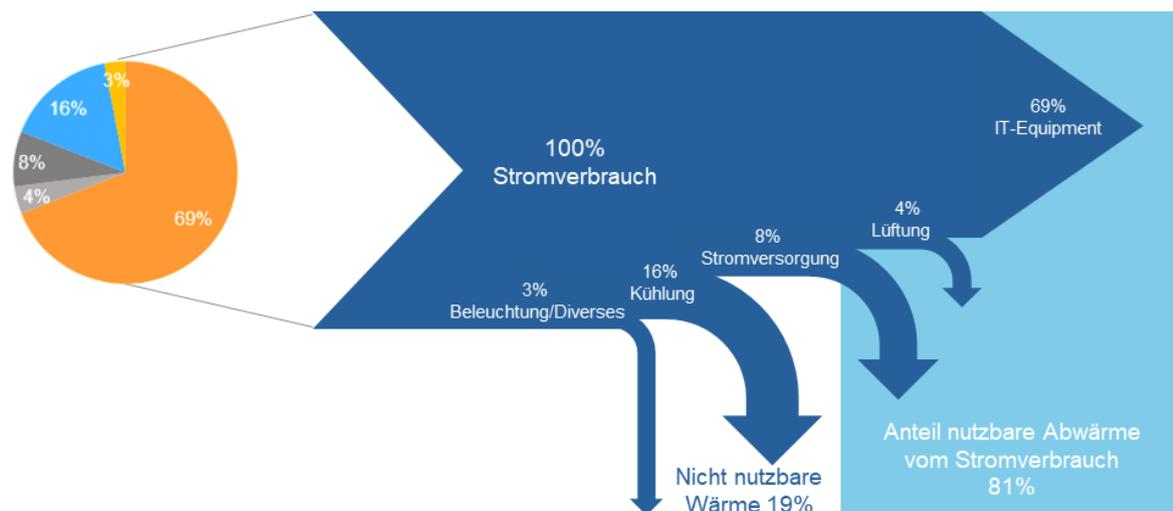
Abbildung 2: Energieflussdiagramm Stromverbrauch und nutzbare Abwärme in Rechenzentren
