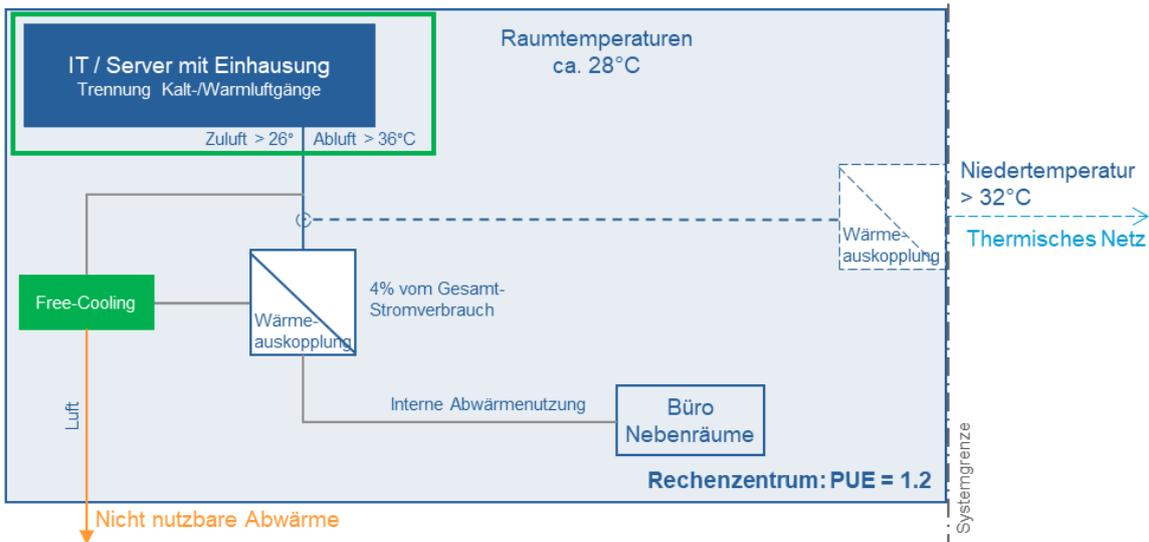
Abbildung 5: Modernes Rechenzentrum – Modernste Infrastruktur mit Abwärmenutzung
