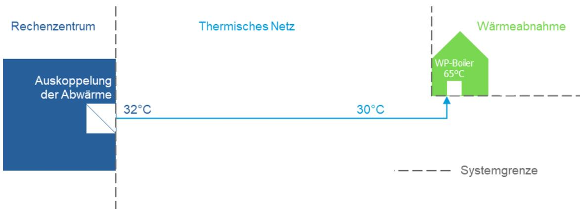
Abbildung 7: Prinzipschema einer direkten Abwärmenutzung in einem Niedertemperaturnetz
