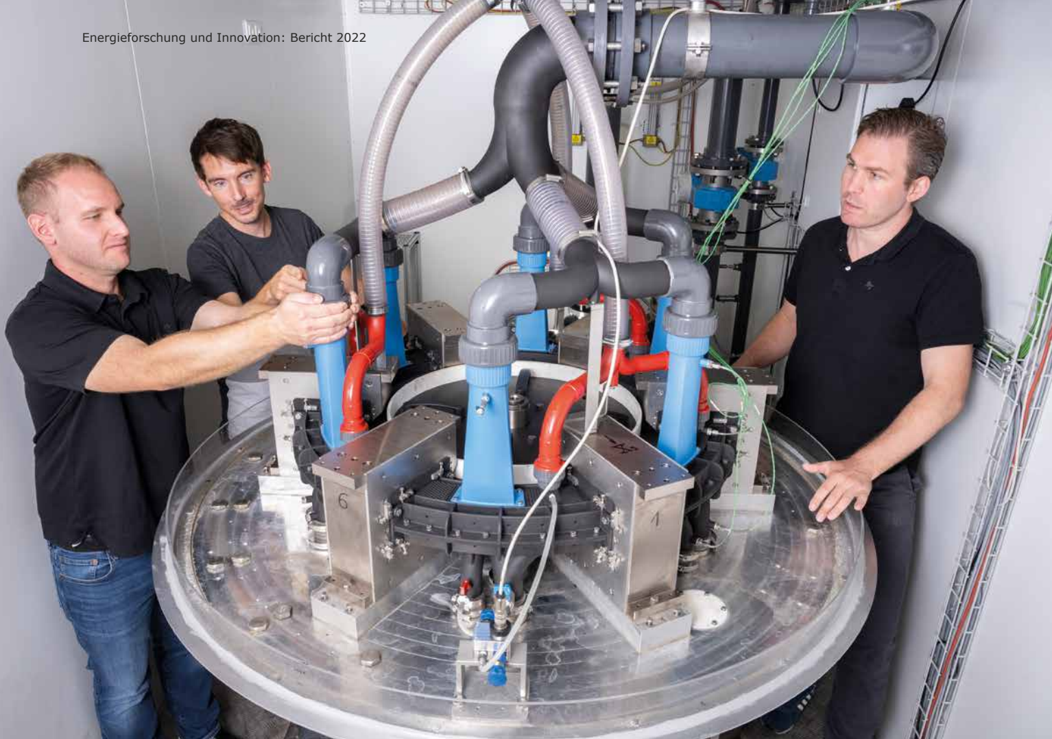
Swiss Blue Energy forscht seit 2012 an der Entwicklung eines Thermo-Magnetischen Motors. Mit diesem Prototyp gelang es dem Ingenieurteam erstmals, mehr Energie zu erzeugen, als für den Betrieb der Pumpen erforderlich ist (Bildquelle: Swiss Blue Energy).
