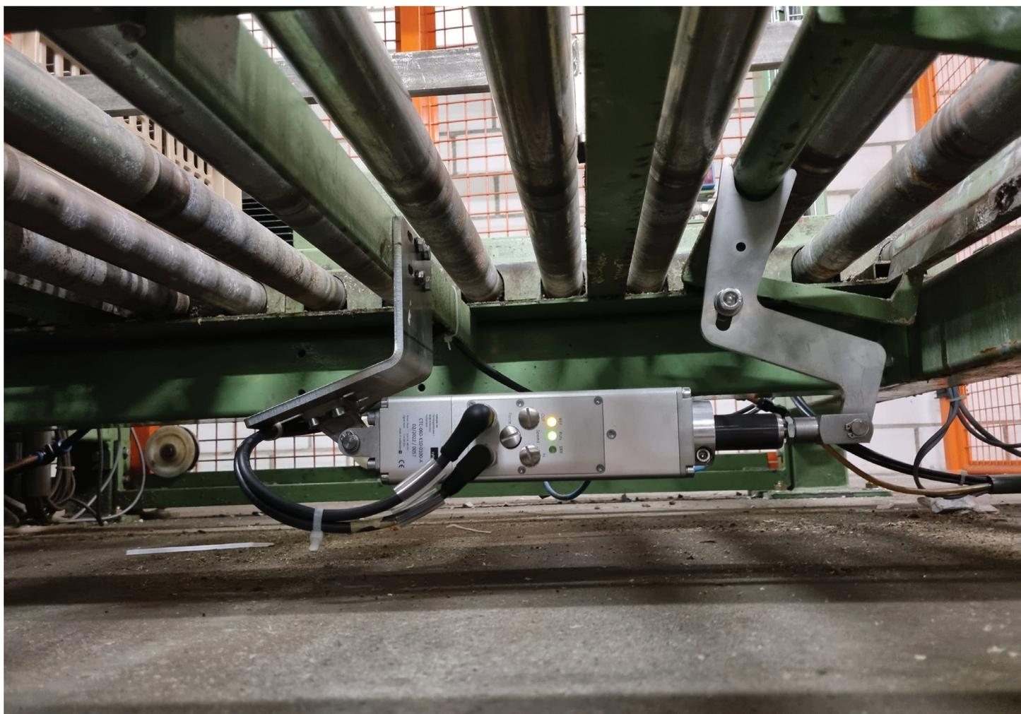
Bei Micarna, dem Fleischverarbeitungsbetrieb der Migros, dienen die im BFE-Pilotprojekt eingesetzten Elektrozyylinder dazu, Gebinde, welche im internen Logistiksystem transportiert werden, abzustoppen und diese in den Folgeprozess einzutakten. Foto: Cyltronic
