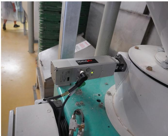
In der Reismühle Nutrex in Brunnen, die zu Coop gehört, sind rund 300 Pneumatikzylinder im Einsatz. Drei von Ihnen wurden im Rahmen des BFE-Pilotprojekts durch Elektrozyylinder ersetzt. Der Elektrozyylinder im Bild dient dem Antrieb von Schwenklappen einer Waage, mit der Reststoffe gewogen werden, die bei der Reisveredelung anfallen. Foto: Cyltronic
