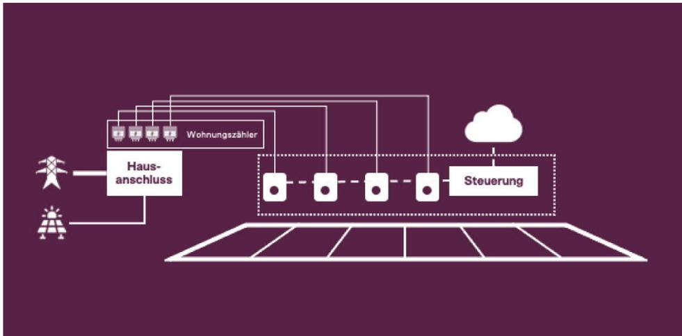
Alternativ kann eine intelligente Ladeanlage auch mittels Einzellerschliessungen der Ladestationen an den Wohnungszählern realisiert werden, sofern die Ladestationen intelligent steuerbar sind. Allerdings ist diese Variante in der Regel mit höheren Kosten verbunden.
