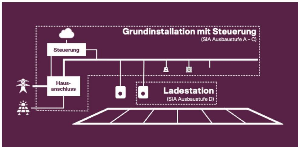
Die Grundinstallation umfasst den Ausbau der Parkanlage zur Vorbereitung auf die Installation von Ladestationen, damit diese zu einem späteren Zeitpunkt bei Bedarf mit wenig Aufwand installiert werden können. Dabei handelt es sich um die Stromzuleitung zu den Parkplätzen, die elektrischen Schutz-einrichtungen sowie allfällige Kommunikationsverkabelungen und Haupt- / Kontrollzähler.
