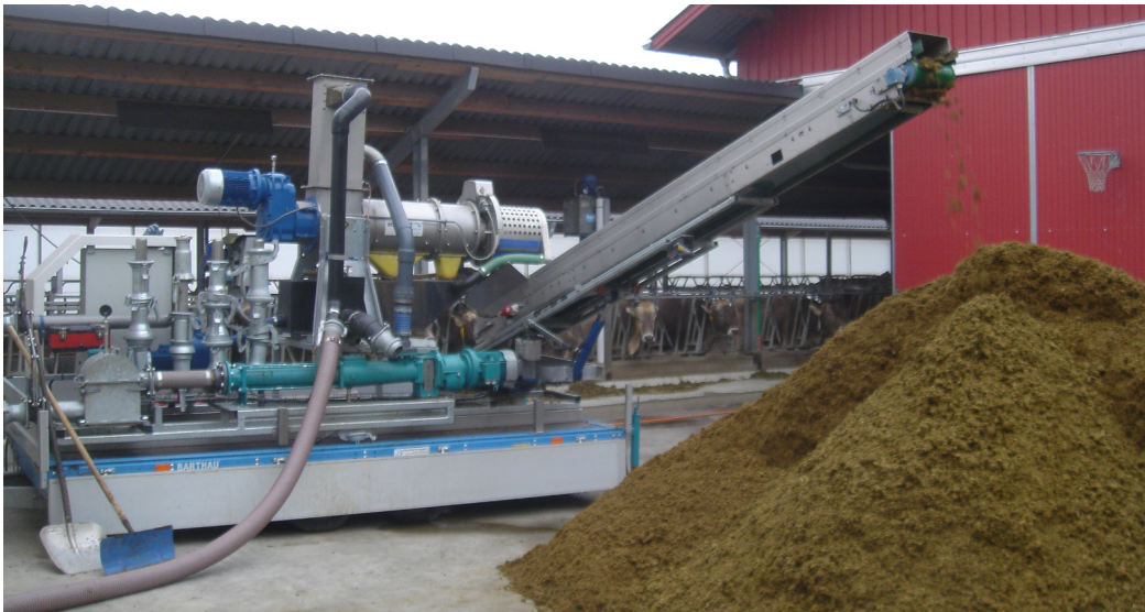
Mobile Anlage zur Auftrennung (Separierung) von Hofdünger in flüssige und feste Bestandteile. Foto: Jean-Louis Hersener
