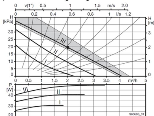
Abbildung 1: p/V- und Leistungsdiagramm, Quelle: Biral MX 12
