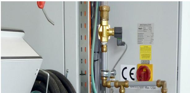
Magnetventil koppelt Maschine automatisch vom Druckluftnetz ab.
