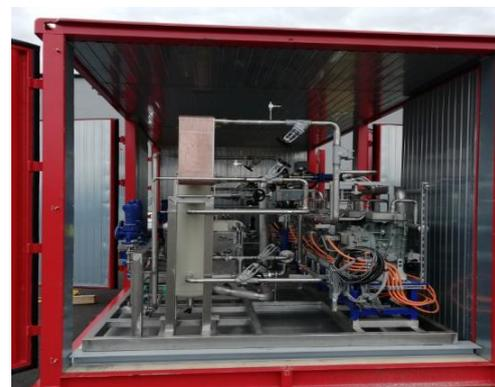
Bild 5: Außenansicht des Wärmepumpencontainers für die Ziegel Trocknung vor dem Einbau (links), Blick in den Container vor den Isolierungsarbeiten (rechts)
